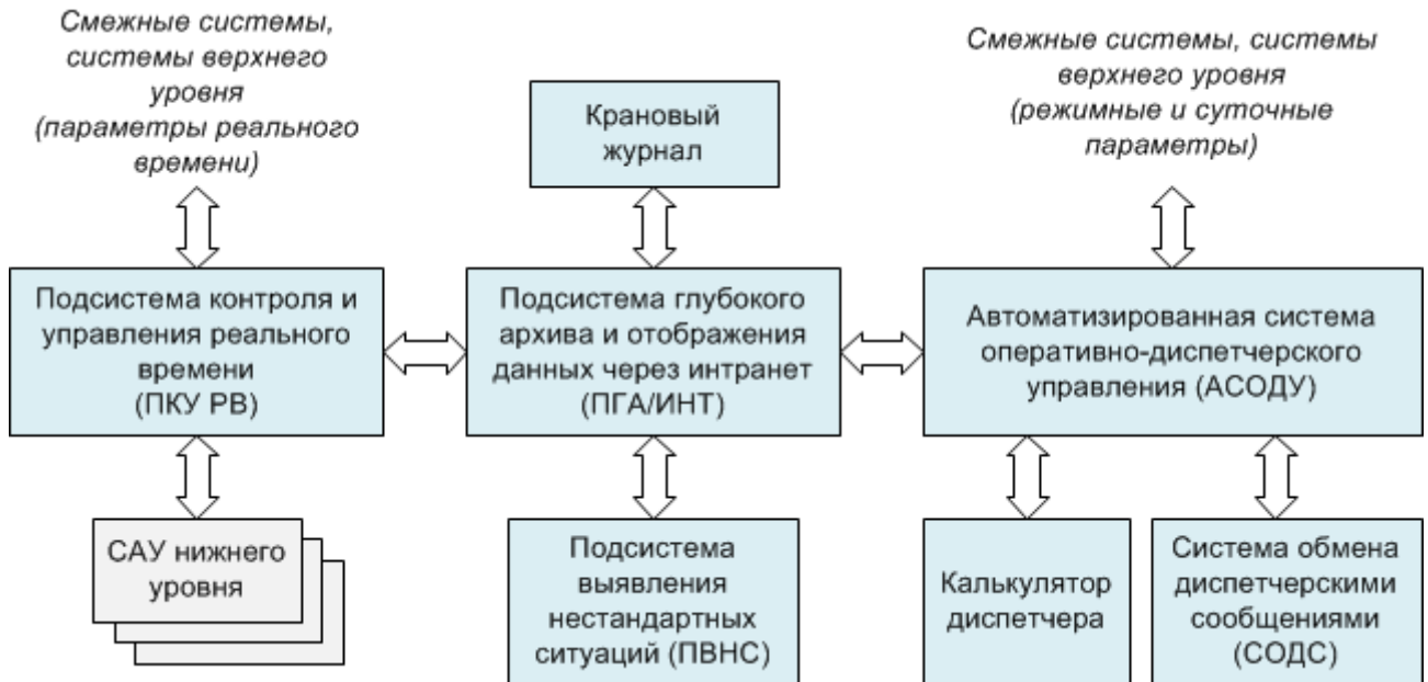
Рис.П.2 Структура функциональных подсистем ПТК СПУРТ-Р
